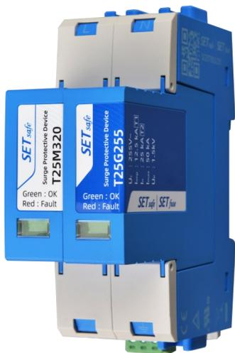
电涌保护器Surge Protection Device (SPD)，也叫防雷器，是一种为各种电子设备、仪器仪表、通讯线路提供安全防护的电子装置。当电气回路或者通信线路中因为外界的干扰突然产生尖峰电流或者电压时，电涌保护器 (SPD) 能在极短的时间内导通分流，从而避电(浪)涌对回路中其他设备的损害。
